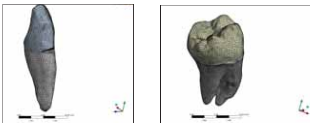
FIGURA 2. Modelul geometric discretizat al dinților incisiv și molar
