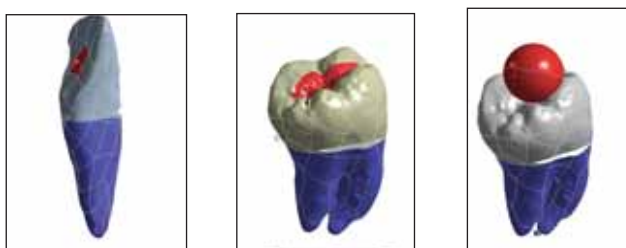
FIGURA 3. Modelul geometric și încărcările aplicate pentru cazurile de solicitare
